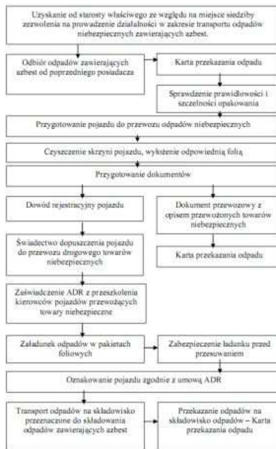
Rysunek 5. Schemat Procedury 5 dotycząca przygotowania i transportu odpadów niebezpiecznych zawierających azbest.
