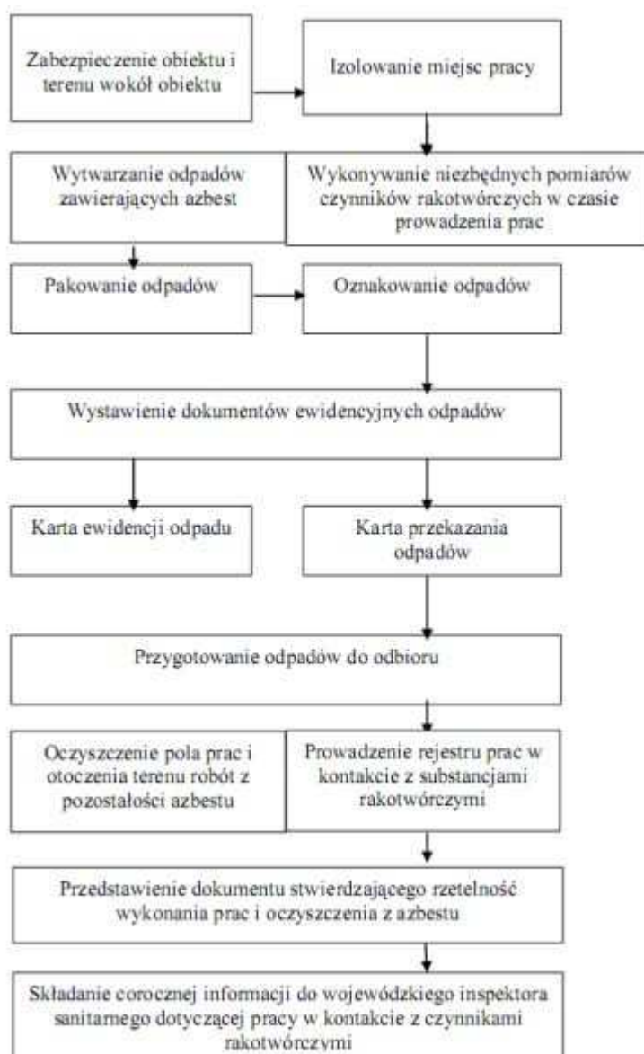
Rysunek 4. Schemat Procedury 4 dotycząca prac polegających na usuwaniu wyrobów zawierających azbest, wytwarzaniu odpadów niebezpiecznych, raz z oczyszczaniem obiektu/terenu/instalacji azbestu. Źródło: Dyczko J. (2007). Szkoła „Azbest – bezpieczne postępowanie” Bezpieczne postępowanie z azbestem i materiałami zawierającymi azbest. 20-21 września 2007, AGH Kraków
